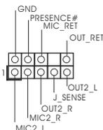
此接口用于将音频设备连接到前音频面板。
