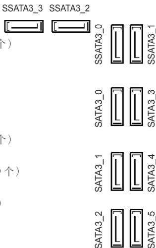
这十个 SATA3 接口支持最高 6.0 Gb/s 数据传输速率的内部存储设备的 SATA 数据线。SSATA3\_3 接口与 M2\_1 共用；SSATA3\_2 接口与 M2\_2 共用。如果 Ultra M.2 Socket 已被占用，内部 SSATA3\_2 将不工作。
