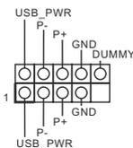
除 I/O 面板上的两个 USB 2.0 端口外，此主板上还有两个接脚和一个端口。每个 USB 2.0 接脚可以支持两个端口。
