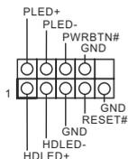
按照下面的针脚分配，将机箱上的电源开关、重置开关和系统状态指示灯连接到此接脚。在连接线缆前请记下正负针脚。
