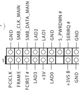
此接口支持 Trusted Platform Module (信任平台模块, TPM) 系统, 可以安全地存储密钥、数字证书、密码和数据。TPM 系统也可以帮助增强网络安全, 保护数字身份和确保平台完整性。
