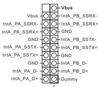
此主板上有两个接头。每个 USB 3.0 接脚可以支持两个端口。
