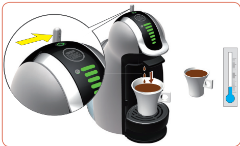
如果仅流出小滴的饮料或饮料比平常要凉，则必须对机器进行除垢。
